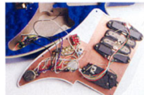
一見、普通のシングルコイルに見えるフロント/センターだが、ピックガードの下にはハム・キャンセル用ピックアップがセットされているのだ。
