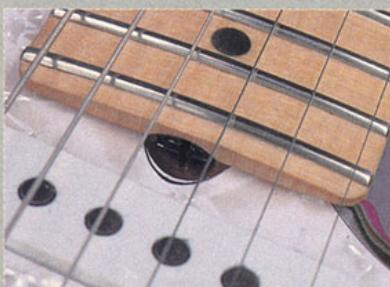
▲トラス・ロッドの調整はどちらから行なう。ロッドの溝はプラス型の刻み。なんと丁寧に指板側もセンターだけ、とてもきれいに削り取られている。
