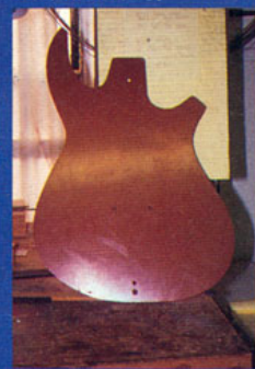
●ボディ外形用のジグ。アルティメイト・ウェポン用で、ベークライトという素材で作られている。
