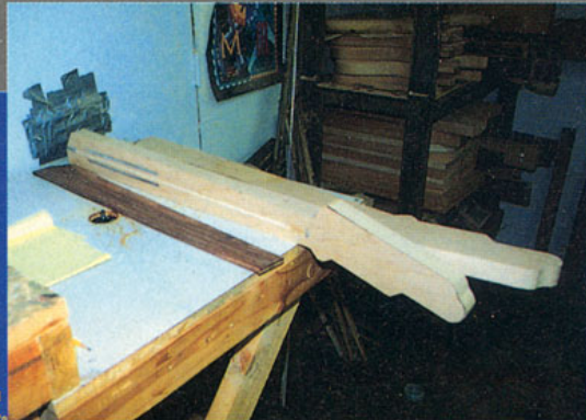
●指板を接着する前のベース・ネック。よく見るとボディ側の裏に近い部分に、トラスロッドを挟み込むようにして補強材が仕込まれているのがわかる。
