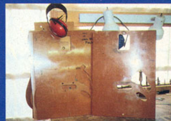
●これはネック・ポケット、ブリッジ、コントロール・キャビティをルーターでカットするためのジグだ。おそらくピックアップのキャビティはS-S-H、S-S-S、などのコンポーネーションのプレートが別になって、それらをフレキシブルに組み合わせるのだろう。
