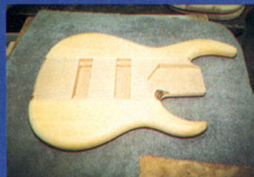
●塗装工程前の生地ボディ。5弦ベースのもので、センター・ピースがアルダー。両側にはMAMYWOというマレーシア産の材が使われている。
