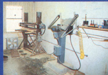
●作業にはかなり特殊なマシンが使われる。この2台はサンダーだ。
