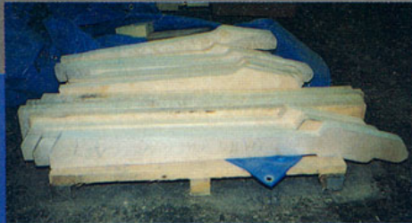
●バンドソーでおおまかにカットされたネック材。手前はベースのためのプランク。中央にはまた板状のものが見られる。奥には美しい木目の入ったものもある。
